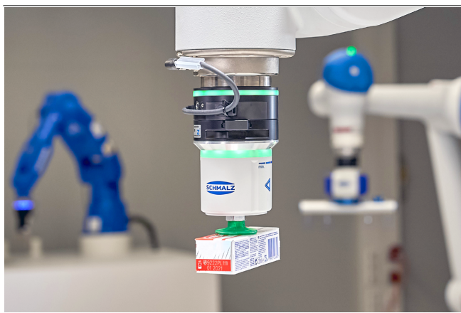
Generatore di vuoto elettrico ECBPMi MATCH per la movimentazione di piccoli cartoni
